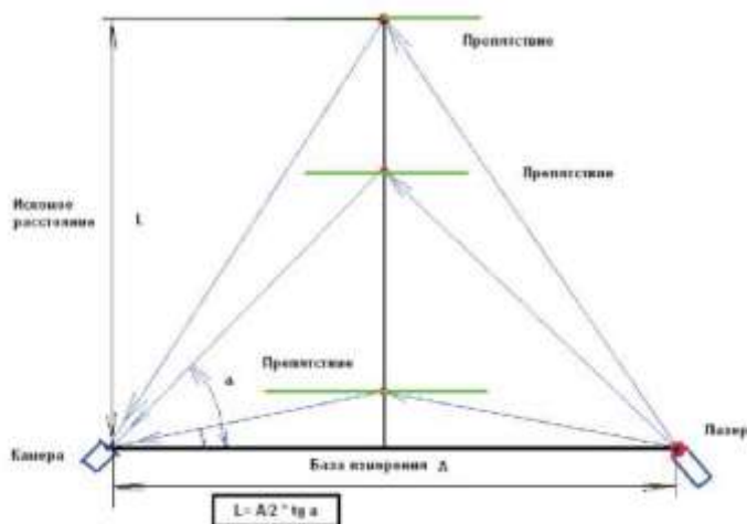
Рис. 75. Метод измерения ИК-дальномером
